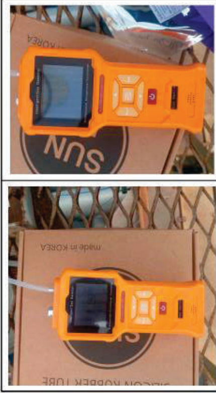
가스측정 - 아스콘설비 가동전
